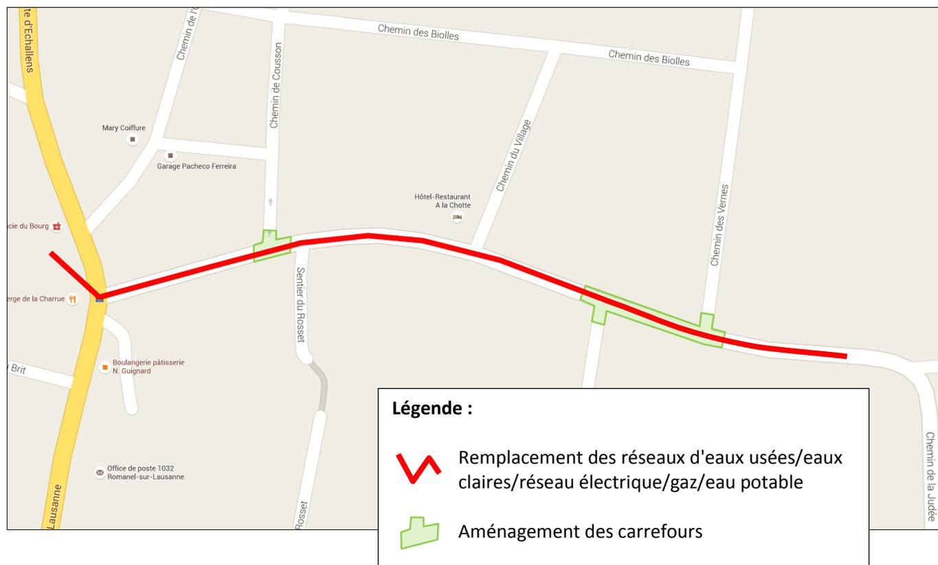
Les travaux envisagés sont le remplacement des canalisations d'Eaux Claires et d'Eaux Usées, le remplacement de la conduite de gaz et d'eau datant toutes deux de 1971, ainsi que le remplacement du réseau électrique. L'opportunité de remplacement des réseaux Swisscom et de fibre optique sera également envisagée.
